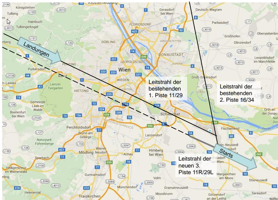
Die „alte 2. Piste“ 16/34 wird hierbei stillgelegt, da die Flugzeuge diese als Rollweg benutzen. **Der Flughafen hat mit diesem Szenario der Parallelpisten 1 und 3 die maximale Kapazität.** Zum Vergleich, London Heathrow wickelt über ein solches 2-Pisten Parallelsystem jährlich rund **470.000 Flugbewegungen mit rund 73 Mio. Passagier** ab (2014).
